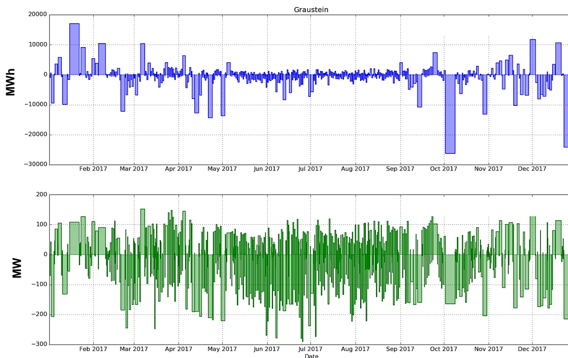
Abb. 3.5: Durchschnittlicher Leistungsfluß (grüne Kurve in MW) und Energieaustausch (blaue Kurve in MWh) zwischen 400 kV und 110 kV in der Umspannanlage Graustein in 2017
